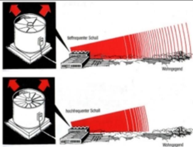
Abbildung 5.18: Schematische Darstellung der Auswirkung der Luftabsorption auf dem Ausbreitungsweg von tief- und hochfrequentem Schall bis zum Immissionsort (Quelle: Ingemannsson, S., 2003)
